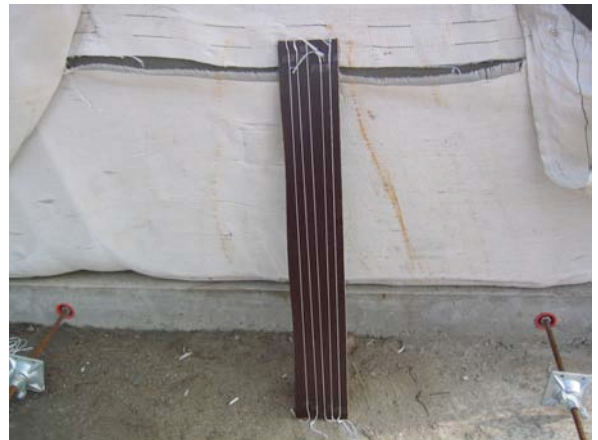
Foto 8: Nemen van stalen volgens EN ISO normen veroorzaakt onaanvaardbare schade (insnede boven), chirurgisch verwijderen van garens voor beproeving is aanvaardbaar (onzichtbare verwijdering van het garen onder). De proefgarens worden op een plank gekleefd voor transport naar het laboratorium.
